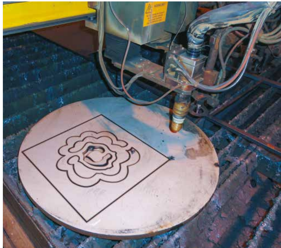
Die Kunstwerke werden in einem Stahlwerk mittels Plasmatechnik „ausgeschnitten“.
